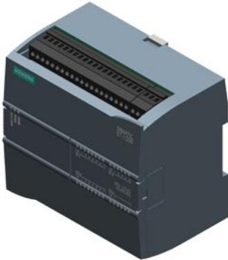
SIMATIC S7-1200, CPU 1214C, CPU compacta DC/DC/DC, E/S INTEGRADAS: 14 DI 24 V DC; 10 DO 24 V DC; 2 AI 0-10V DC, alimentación: DC 20,4-28,8V DC, Memoria de programas/datos 100 KB
